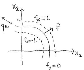
Betrachte System mit Zwangsbedingungen  $f_\alpha = 0$ , vorerst in kartesischen Koordinaten  $\vec{r}$ . Zwangskraft ist orthogonal zur Oberfläche  $f_\alpha(\vec{r}) = 0 \Rightarrow$
