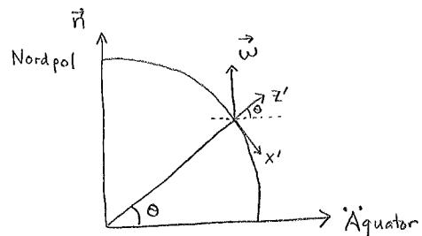
$$\Rightarrow -2m\vec{\omega} \times \vec{r}' = 2m \begin{vmatrix} \vec{e}'_x & \vec{e}'_y & \vec{e}'_z \\ \dot{x}' & \dot{y}' & \dot{z}' \\ -\omega \cos \Theta & 0 & \omega \sin \Theta \end{vmatrix} = 2m\omega \left\{ \begin{array}{l} y' \sin \Theta \vec{e}'_x \\ -(\dot{x}' \sin \Theta + \dot{z}' \cos \Theta) \vec{e}'_y \\ + \dot{y}' \cos \Theta \vec{e}'_z \end{array} \right\}.$$
